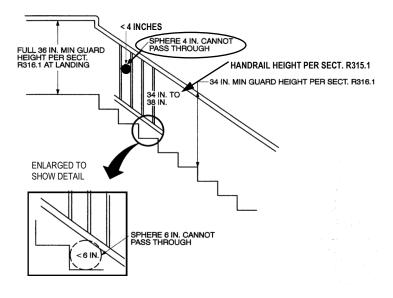
IF STAIR IS MORE THAN 30 IN. ABOVE THE FLOOR BELOW AT ANY POINT OF THE STAIR'S FLIGHT, A GUARD IS REQUIRED ALONG THE OPEN SIDE.
